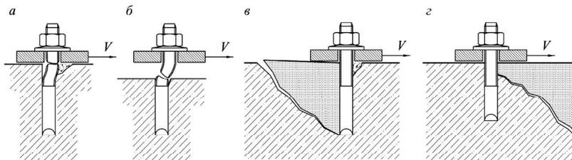
*a* – разрушение по стали анкера без плеча силы; *б* – разрушение по стали анкера с плечом силы; *в* – разрушение от выкалывания бетона основания за анкером для одиночного анкера; *г* – разрушение от откалывания края основания.
