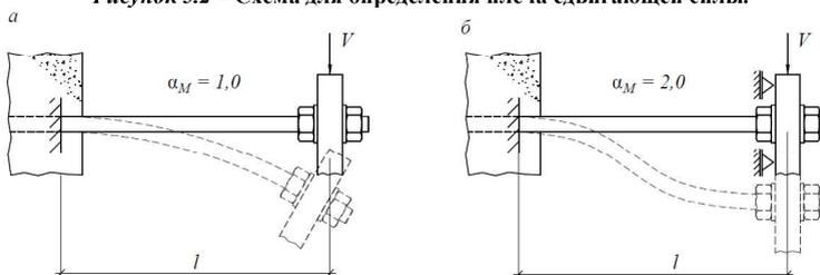
**Рисунок 5.3 – Расчетная схема для определения степени защемления анкера.**
