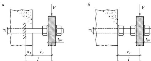
**Рисунок 5.2 – Схема для определения плеча сдвигающей силы.**
