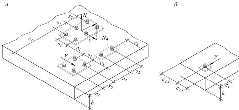
Рисунок 3.1 – Обозначение параметров взаимного расположения анкеров
