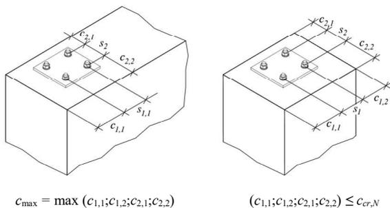
Рисунок 6.5 – Схема расположения анкеров в стесненных условиях.
