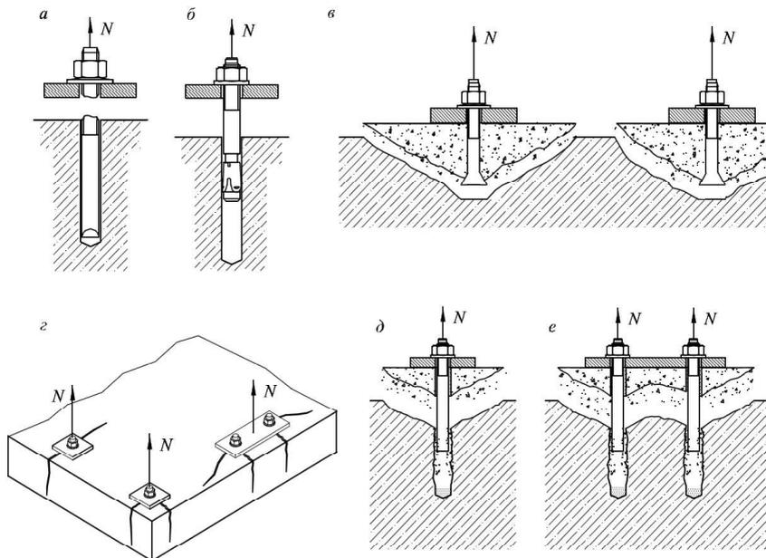
*a* – разрушение по стали анкера; *б* – разрушение по контакту с основанием; *в* – разрушение от выкалывания бетона основания; *г* – разрушение от раскалывания основания; *д* – комбинированное разрушение по контакту анкера с основанием и выкалыванию бетона основания при одиночном анкере (для клеевых анкеров); *е* – то же для группы анкеров.
