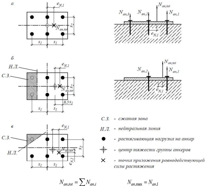
*a* – эксцентриситет в одном направлении, все анкеры растянуты; *б* – эксцентриситет в одном направлении, растяжение только для части анкеров; *в* – эксцентриситет в двух направлениях, растяжение только для части анкеров.
